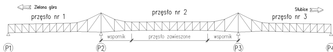
Ryc. 2 Schemat konstrukcji istniejącego mostu w Krośnie Odrzańskim.
